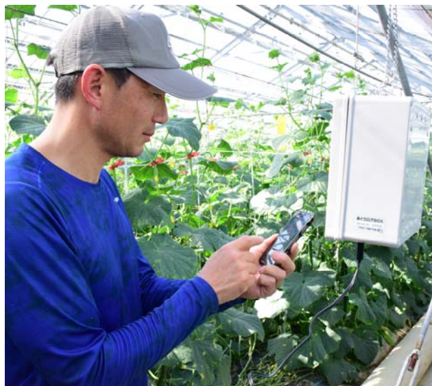
環境測定器「あぐりログBOX」（白い箱）と、スマートフォンで温度・湿度などを確認します
