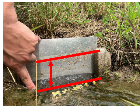
平時の水位との10cmの差で、豪雨時に100t/1000㎡貯水可能
