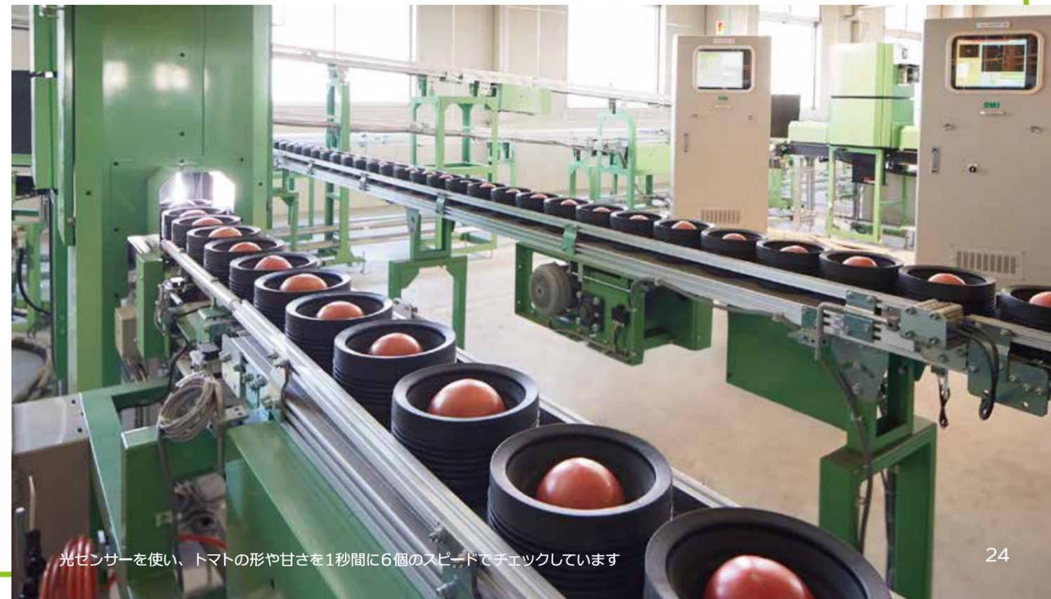
光センサーを使い、トマトの形や甘さを1秒間に6個のスピードでチェックしています
